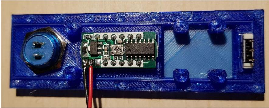
Das positive Kabel des Voltmeters führe ich zu der Seite des Tasters welche durch den Schiebeschalter mit Spannung versorgt wird.
